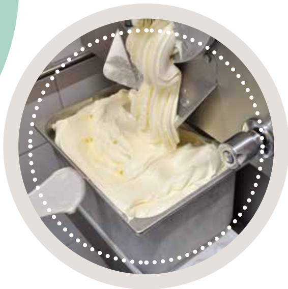
Die Eismasse kommt frisch aus der Maschine. Jetzt muss sie gekühlt werden.
